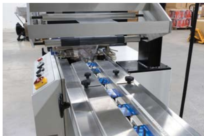
L'ensacheuse horizontale sert à mettre des cartes d'appel sous pellicule plastique.
